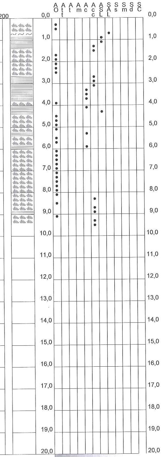
**PROVA PENETROMETRICA STATICÀ
