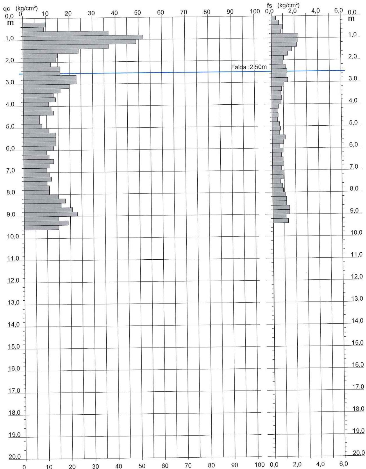
**PROVA PENETROMETRICA STATICÀ
