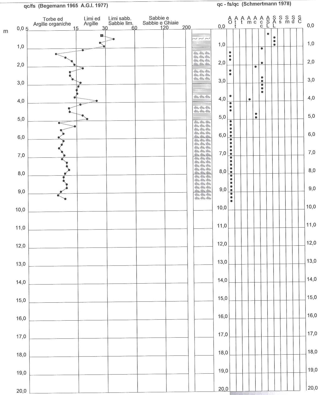
**PROVA PENETROMETRICA STATICÀ
