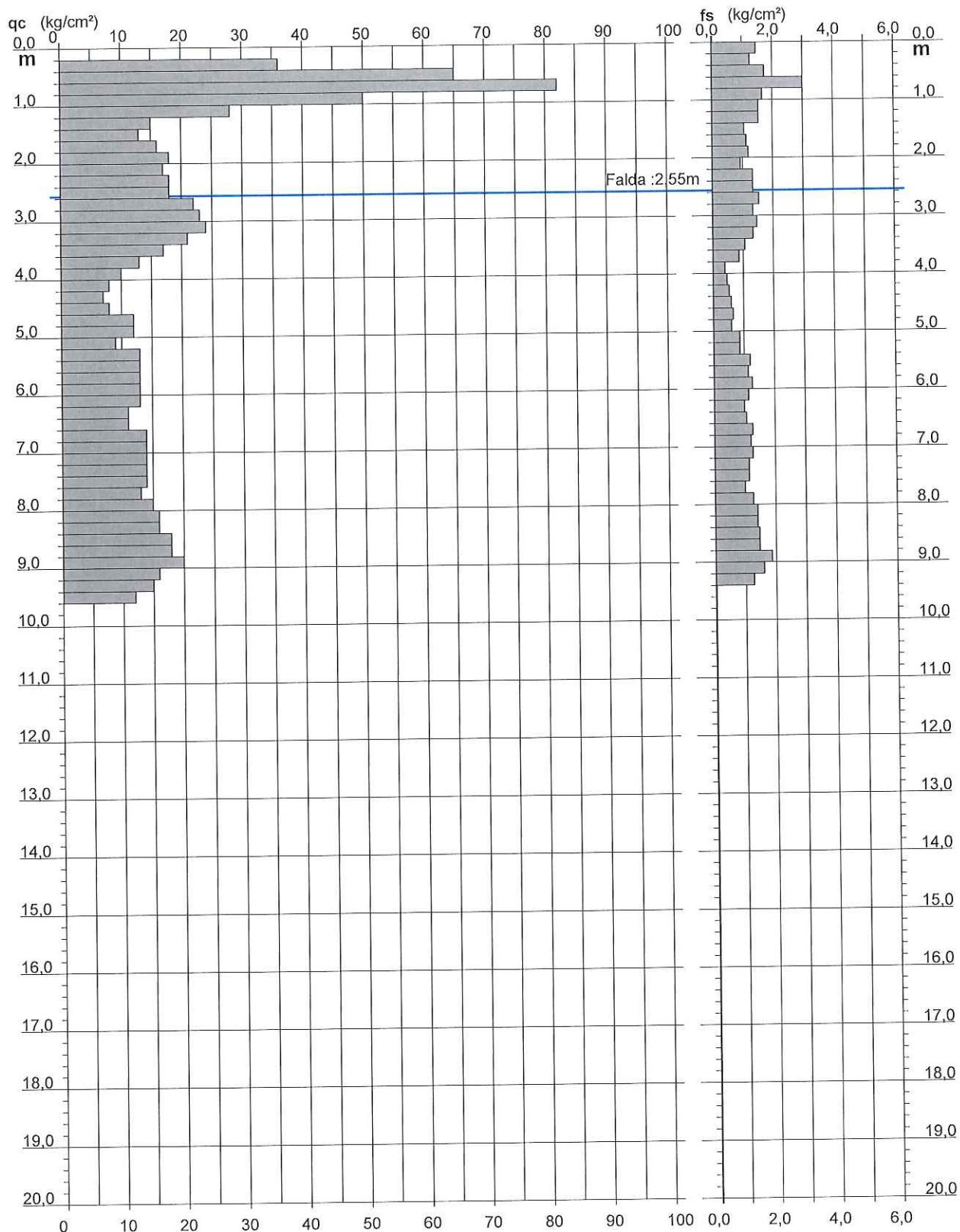
**PROVA PENETROMETRICA STATICÀ
